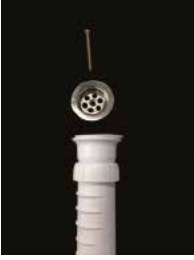
5- Lavabo monte etmek için süzgeç üstü vidasını söküp, metal süzgeç ile plastik taban arasında lavabo kalacak şekilde monte ederiz.
